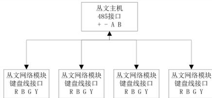
RS485 总线扩展通信模块结构示意图
