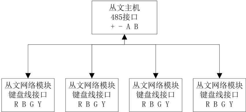
RS485 总线扩展通信模块结构示意图
