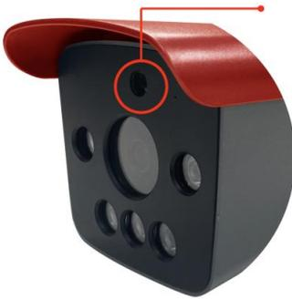
此处传感器易受人体/人手干扰，为了对火焰检测更灵敏，出厂默认的阈值比较低，防止漏报
