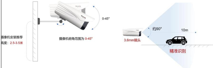
摄像机安装的角度（错误安装实例）
